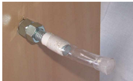
FIGURA 30. BANCADA DE TESTES – DETALHE DO ACOPLAMENTO DO MOTOR (APENAS PARA O TESTE).
