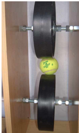
FIGURA 29. BANCADA DE TESTES – DETALHE DA COMPRESSÃO DA BOLA.
