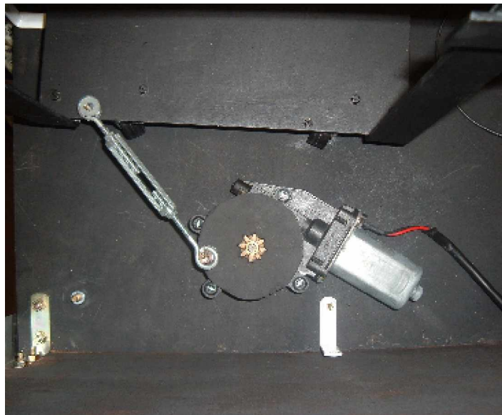
FIGURA 39. QUADRILÁTERO DE MOVIMENTAÇÃO COM HASTE REGULÁVEL.
