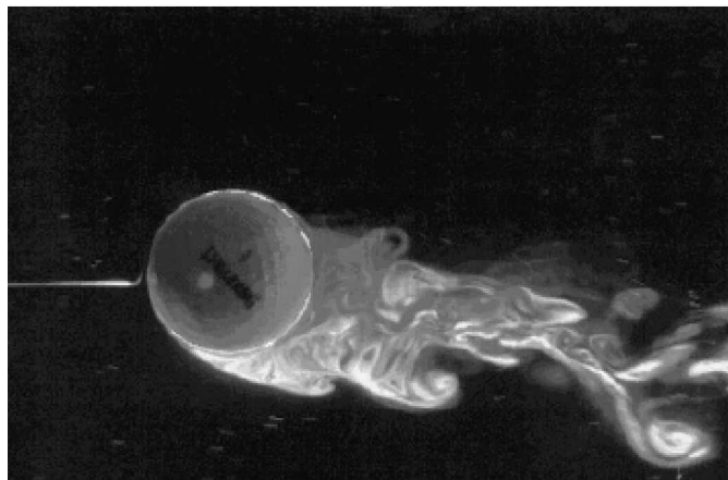
FIGURA 27. SEPARAÇÃO DA CAMADA LIMITE EM UMA BOLA GIRANDO NO SENTIDO HORÁRIO.
